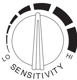
Pred zváraním nastavte citlivosť na vysokú hodnotu, pri relatívne silnom osvetlení (filter sa zatemní). Potom nastavte citlivosť na nižšiu hodnotu, pokiaľ sa filter nevráti do svetlého stavu (nesmerujte kuklu do zdroja svetla, ale k zváranému obrobku). V priebehu zvárania nastavte citlivosť čo najvyššie, aby nebola obmedzená rýchlosť stmievania.
