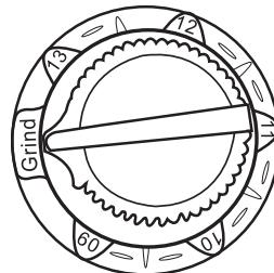
A kapcsoló "Grind" - köszörülés állásában csak az alap sötétedés marad meg, a kapcsoló többi állásban az automatikus elsötétedés fokozatait állíthatjuk be a szükséges DIN értékre.
